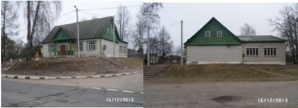
Капитальное строение – **Черевковская сельская библиотека - Дом культуры и свободного времени** (одноэтажное деревянное, обложенное кирпичом, 1959 года постройки. Фундамент – ленточный бутобетонный; стены – бревенчатые; перекрытия – деревянные изделия; крыша – асбестоцементный волнистый лист, отопление - печь), **общая площадь** – 237,9 кв.м, **расположено** по адресу: Мядельский район, Нарочский с/с, д. Черевки, ул. Центральная, 61.
